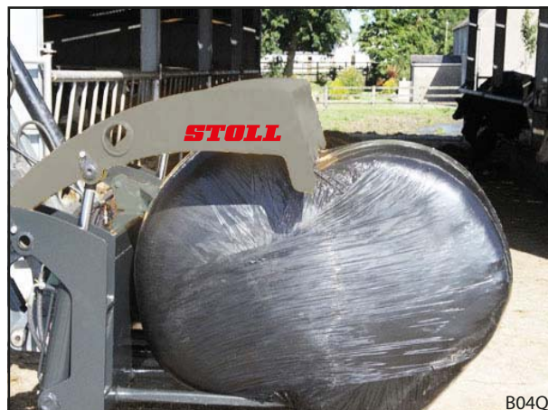
Фиг. 37 Натискане на ръглите бали към основната рама
