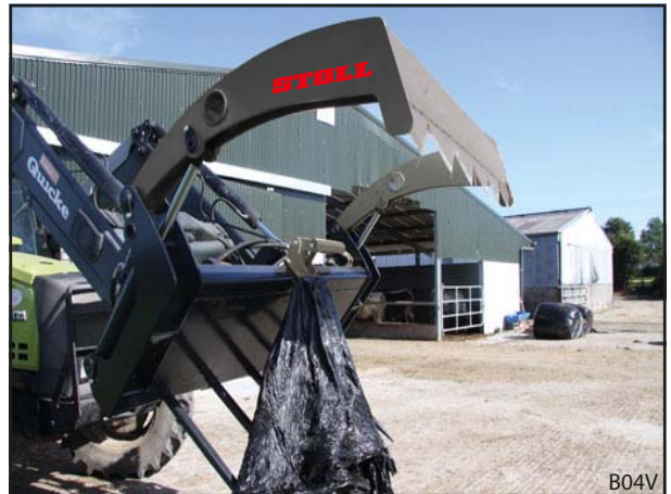
Fig. 42 Aflæsning af plastindpakning
