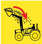
Existe peligro de muerte debido a las cargas elevadas que pueden volcar sobre el asiento del conductor. La elevación de objetos (p. ej. palets o pacas) por encima de la cabina del conductor y el trabajo en pendiente elevan el riesgo. Los sistemas de protección habituales (dispositivo antivuelco ROPS, protección incorporada contra la caída de objetos FOPS) tampoco ofrecen una protección totalmente suficiente.
