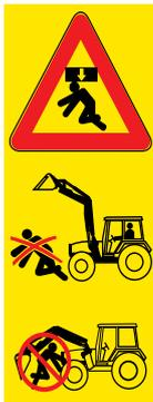
Existe riesgo de lesiones debido a aplastamientos, golpes o atrapamiento si el cargador frontal vuelca o se inclina o bien si se desprende del dispositivo elevador.
