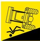
Existe grave riesgo de lesiones y peligro de muerte durante la carga y transporte de carga si está guiando el cargador frontal de un lado, se levanta la carga demasiado sobre el asiento de operador o bien se utiliza implementos inapropiados.
