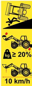
Existe riesgo de graves lesiones y peligro de muerte debido al vuelco del tractor al trabajar en pendientes, en desplazamientos con curvas, con insuficiente peso en el eje posterior y al coger carga diagonalmente.
