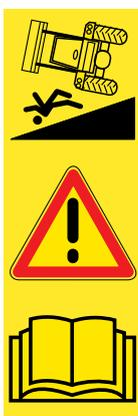
Existe riesgo de lesiones si el cargador frontal vuelca durante el montaje y desmontaje, o bien si el cargador frontal estacionado vuelca debido a la falta de estabilidad.
