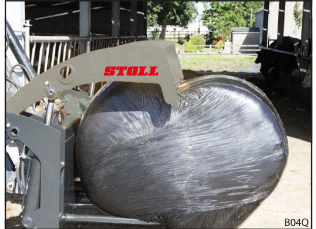
Kuva 37 Pyöröpaalin painaminen päärunkoa vasten
