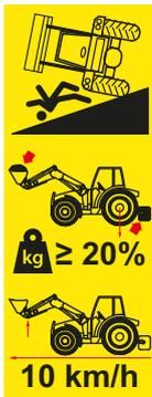
Il y a un risque de blessures graves ou de mort par basculement du tracteur lors de d'un travail sur des terrains en pente, de la conduite dans les virages, de la configuration d'une charge trop faible au niveau de l'essieu arrière et de l'approche en diagonale de la cargaison.
