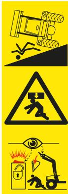
Il y a un risque de blessures graves ainsi que de mort lors du chargement et du transport de charge si le chargeur frontal est mené d'un seul côté, si la charge est soulevée trop loin au-dessus du siège du conducteur et si des outils inadaptés sont utilisés.
