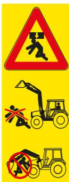
Il y a un risque mortel d'écrasement et de blessure par les mouvements imprévisibles du tracteur, du chargeur frontal ainsi que des outils.
