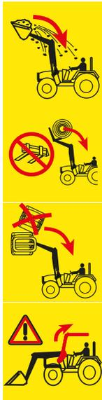
Il y a un risque de mort si les charges relevées peuvent tomber sur le siège du conducteur. Le levage d'objets (par exemple de palettes ou de balles) au-dessus de la cabine de conduite et le travail sur des terrains en pente augmentent le risque. Même les systèmes de protection habituels (dispositif de protection en cas de renversement ROPS, structure de protection contre les chutes d'objets FOPS) ne sont pas suffisants.
