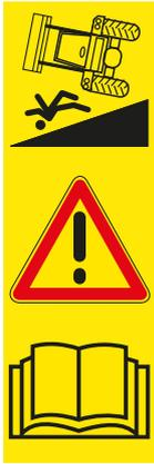
Il y a un risque de blessure si le chargeur frontal se renverse lors du montage ou du démontage ou si le chargeur frontal déposé bascule en raison d'un manque de stabilité.
