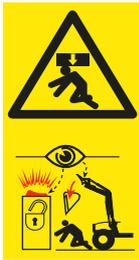
Il y a un risque de blessures graves et de mort par la chute des outils ou par un abaissement incontrôlé du chargeur frontal si des outils inappropriés sont utilisés ou si les outils utilisés sont surchargés.
