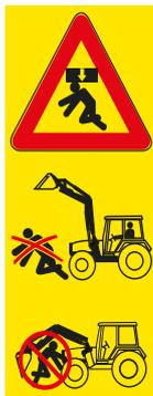
Il y a un risque de blessure par écrasement, heurt ou coincement si le chargeur frontal se renverse, bascule ou tombe du dispositif de levage.
