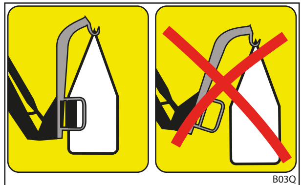
Σχ. 79 Σωστή (αριστερά) και ακατάλληλη θέση (δεξιά) του εργαλείου
