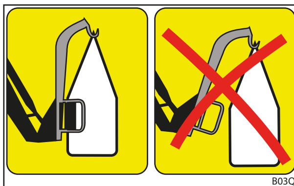
Fig. 79 Correcte (links) en ongeschikte (rechts) stand van het werktuig
