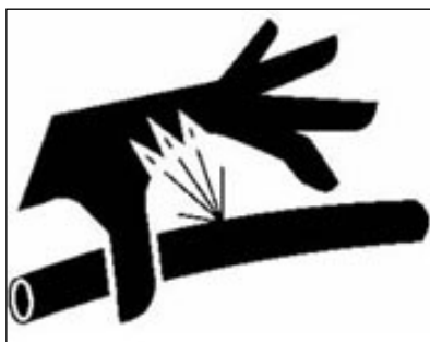
Afb. 4: Risico op verwondingen door hydraulische olie die eruit treedt.
