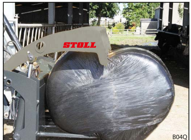
Fig. 37 Premere le balle rotonde contro il telaio principale
