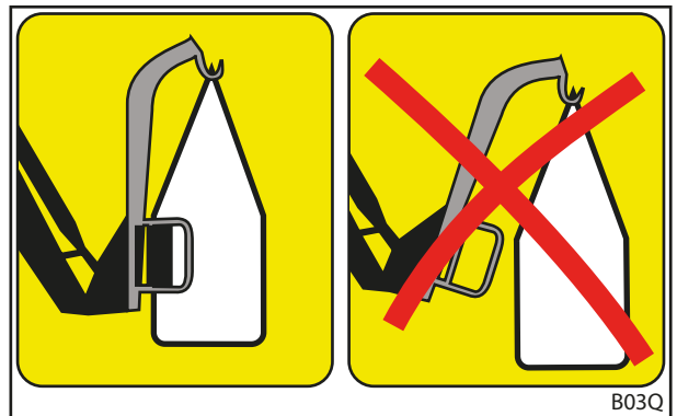
Fig. 79 Posizione corretta (a sinistra) e non appropriata (a destra) dell'attrezzo
