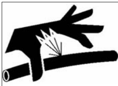
Fig. 4: Le perdite di olio idraulico possono provocare lesioni.
