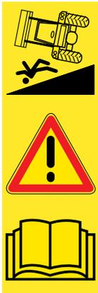
Sussiste pericolo di lesioni se il caricatore frontale ribalta durante il montaggio o lo smontaggio oppure il caricatore frontale depresso si ribalta per mancata stabilità.
