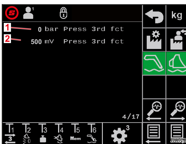
Fig. 40 Sensore di pressione nel 3° circuito di comando
