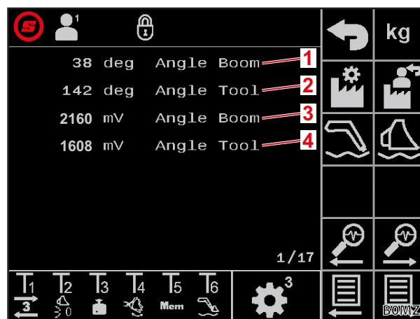
Fig. 37 Sensori angolari di braccio oscillante e attrezzo
