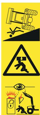
Sussiste il pericolo di gravi lesioni e di morte durante il caricamento e il trasporto del carico, se il caricatore frontale viene guidato unilateralmente, il carico viene sollevato troppo sopra la postazione dell'operatore oppure vengono utilizzati attrezzi non adatti.
