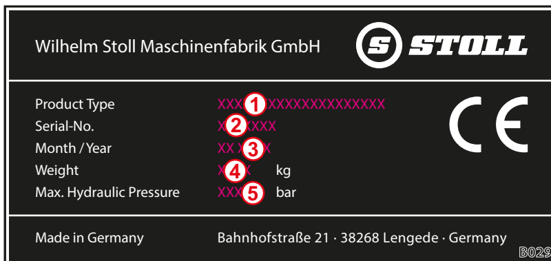
Fig. 1 Targhetta del tipo sul caricatore frontale
