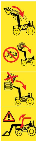
Sussiste pericolo di morte dovuto a carichi sollevati che possono ribaltare sul sedile del conducente. Il rischio aumenta in caso di sollevamento di oggetti (ad es. pallet o balle) sopra la cabina del conducente e di lavoro su pendii. Anche i comuni sistemi di protezione (dispositivo antiribaltamento ROPS, strutture di protezione contro la caduta del carico FOPS) non offrono una protezione completamente sufficiente.
