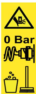
Sussiste pericolo di schiacciamento se parti della macchina si muovono in modo incontrollato nel sistema idraulico a causa di inclusioni d'aria.
