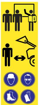
Sussiste pericolo di schiacciamento e urto degli arti superiori e inferiori dovuto a elementi del telaio protuberanti e sporgenti ed a componenti mobili della macchina.
