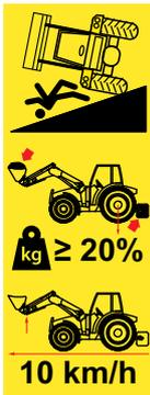
Sussiste il pericolo di gravi lesioni e di morte a causa del ribaltamento del trattore, durante i lavori su pendii, nelle curve, in caso di peso insufficiente sull'asse posteriore e quando ci si avvicina al carico trasversalmente.
