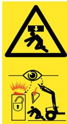
Sussiste il pericolo di lesioni gravi e di morte dovuto alla caduta di attrezzi oppure a causa di un abbassamento incontrollato del caricatore frontale, se vengono utilizzati attrezzi non adatti oppure gli attrezzi utilizzati sono sovraccaricati.
