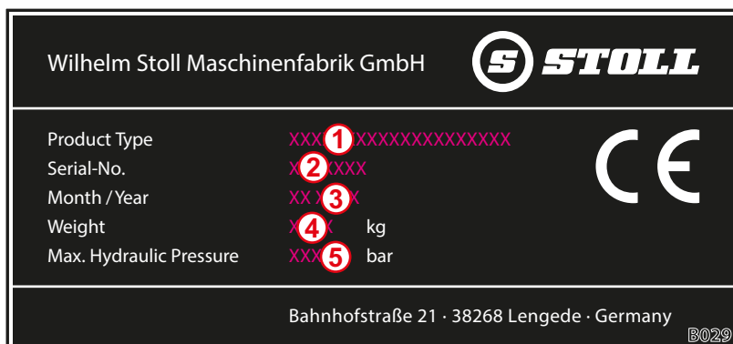
Att. 1 Datu plāksnīte uz frontālā iekrāvēja
