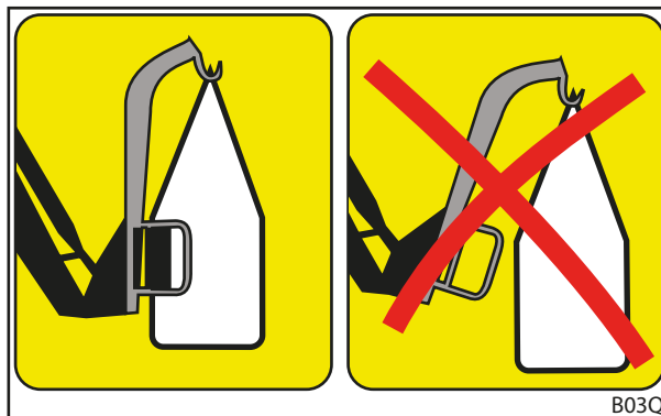
Att. 79 Aprīkojuma pareizs (pa kreisi) un nepareizs (pa labi) stāvoklis
