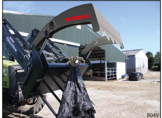
Fig. 42 Lesse av plastfolien
