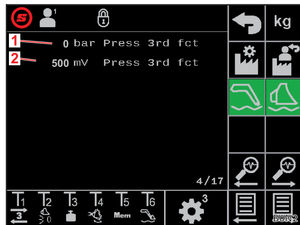
Rys. 40 Czujnik ciśnienia w 3. obwodzie sterowniczym
