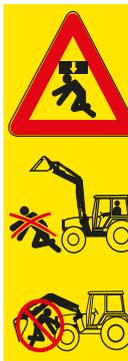
Existe perigo de esmagamento e de ferimento fatal devido aos movimentos imprevistos do trator, do carregador frontal e das ferramentas.
