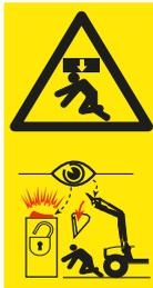
Existe perigo de ferimento grave e de vida devido à queda de ferramentas ou devido ao rebaixamento não controlado do carregador frontal se utilizar ferramentas inadequadas ou se sobrecarregar as ferramentas utilizadas.
