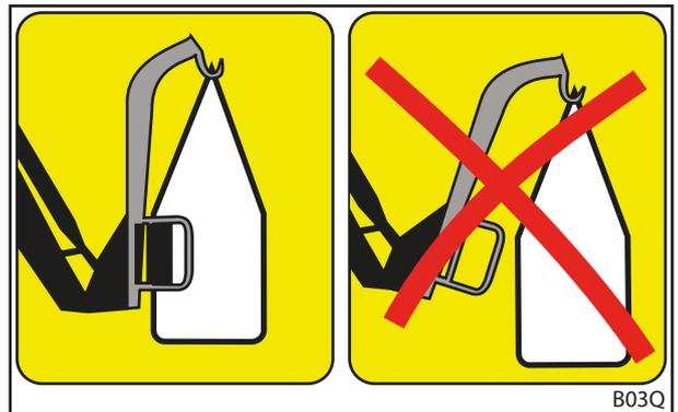
Fig. 79 Posição correta (à esquerda) e incorreta (à direita) da ferramenta
