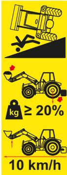
Existe perigo de ferimentos graves ou de morte devido ao capotamento do trator nos trabalhos em declives, nas curvas, ao arrancar, com carga insuficiente no eixo traseiro e ao carregar a carga numa inclinação.
