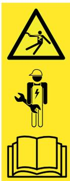
Existe perigo de vida devido a choque elétrico ao tocar peças da máquina sob tensão, p. ex. devido a curto-circuito na rede de bordo do trator.
