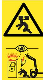
Existe perigo de ferimento grave e de vida devido à queda de ferramentas ou devido ao rebaixamento não controlado do carregador frontal se utilizar ferramentas inadequadas ou se sobrecarregar as ferramentas utilizadas.
