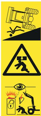
Existe perigo de ferimento, assim como de morte no carregamento e no transporte de carga se o carregador frontal for guiado de um só lado, se a carga for levantada demasiadamente por cima do posto do utilizador ou se forem utilizadas ferramentas inadequadas.
