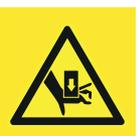
Existe perigo de esmagamento dos membros ao utilizar os apoios de descanso para estacionar o carregador frontal, principalmente em caso de solo irregular.
