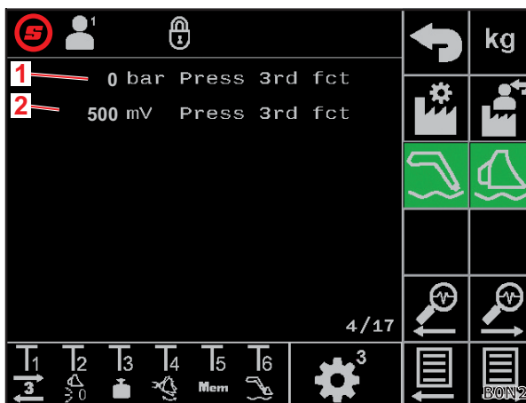
Рис. 40 Датчик давления в 3-й линии гидравлики
