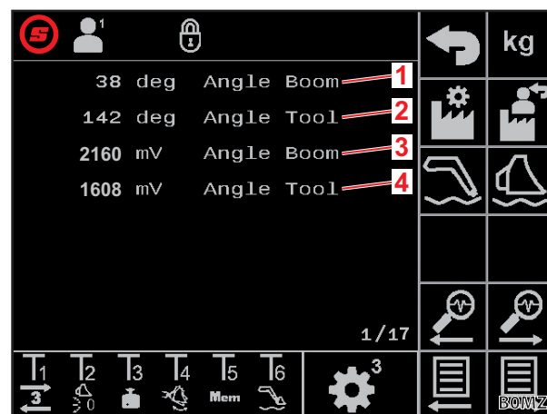
Рис. 37 Датчики угла для стрелы и рабочего органа
