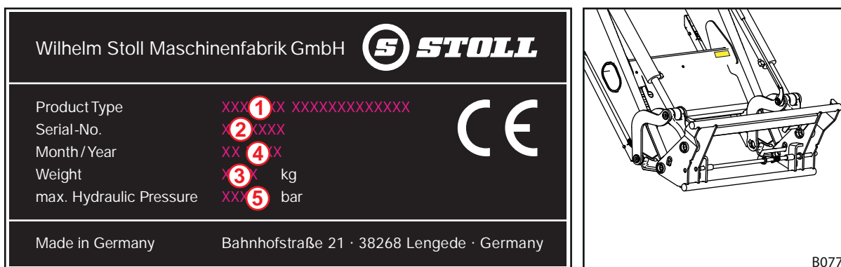
Рис. 1 Заводская табличка на фронтальном погрузчике
