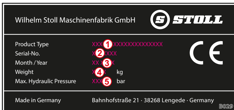
Рис. 1 Заводская табличка на фронтальном погрузчике
