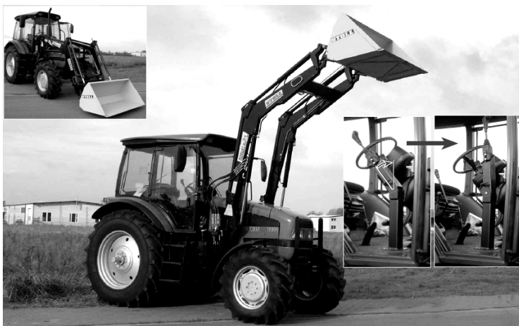
Внешний вид трактора МТЗ 1222 с установленным на нем фронтальным погрузчиком STOLL ROBUST F 31 HDPM
