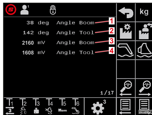
Fig. 37 Vinkelsensorer till lastarm och redskap
