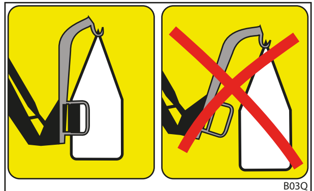
Fig. 79 Korrekt (till vänster) och olämpligt läge (till höger) för redskapet
