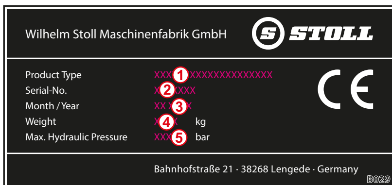
Obr. 1 Typový štítok na čelnom nakladači
