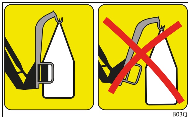
Obr. 79 Správna poloha (vľavo) a nevhodná poloha (vpravo) nástroja
