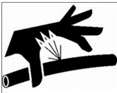
Slika 4: Nevarnost poškodb zaradi iztekajočega hidravličnega olja.
