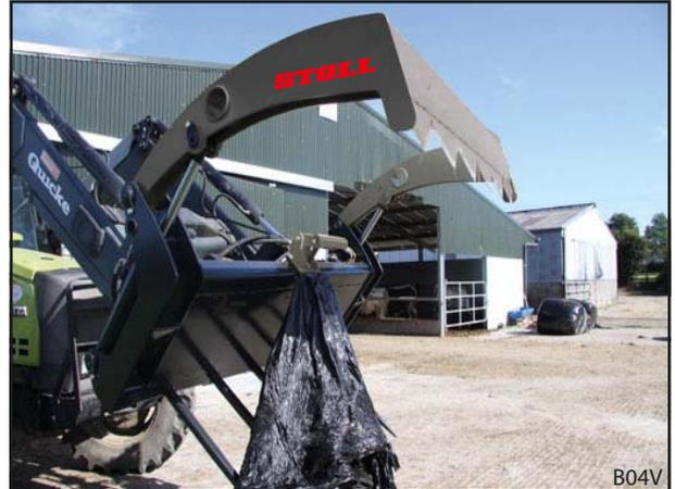
Fig. 42 Descargar la lámina de plástico
