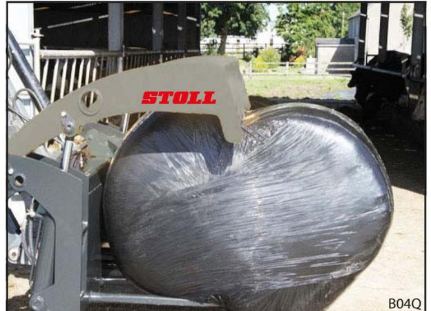
Fig. 37 Presionar las pacas redondas contra el bastidor principal
