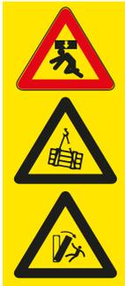
Existe riesgo de lesiones debido a aplastamientos, golpes o atrapamiento si el implemento vuelca o se inclina o bien si se desprende del dispositivo elevador.
