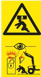
Existe grave riesgo de lesiones y peligro de muerte debido a la caída de implementos o debido al descenso incontrolado del cargador frontal si se utilizan los implementos inapropiados o los utilizados están sobrecargados.
