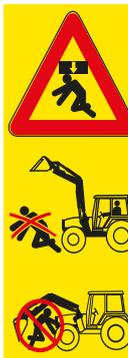
Existe riesgo de aplastamiento y lesiones muy graves debido a movimientos imprevistos del tractor, del cargador frontal así como de los implementos.
