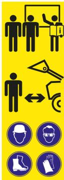
Existe riesgo de aplastamiento o golpes de los miembros superiores e inferiores debido a piezas del bastidor salientes o en voladizo así como componentes móviles de la máquina.
