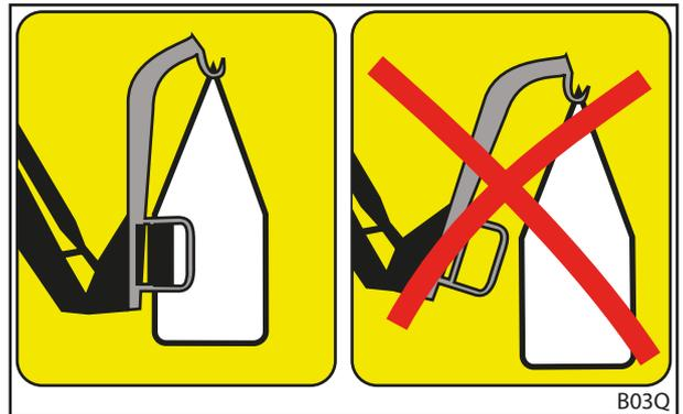
Fig. 79 Posición correcta (izquierda) e inadecuada (derecha) del implemento
