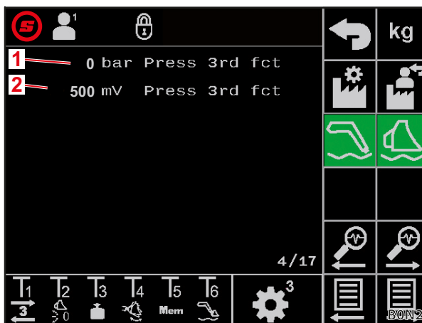
Fig. 40 Sensor de presión en el 3er circuito de control
