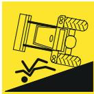
Existe riesgo de accidente durante el transporte del cargador frontal si no se ha cargado y asegurado correctamente.
