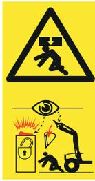
Existe grave riesgo de lesiones y peligro de muerte debido a la caída de herramientas o debido a el descenso incontrolado del cargador frontal si se utilizan herramientas inapropiadas o las utilizadas están sobrecargadas.
