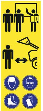
Existe riesgo de aplastamiento o golpes de los miembros superiores e inferiores debido a piezas del bastidor salientes o en voladizo así como componentes móviles de la máquina.
