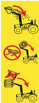
Existe peligro de muerte debido a las cargas elevadas que pueden volcar sobre el asiento del conductor. La elevación de palets o pacas por encima de la cabina del conductor y el trabajo en pendiente elevan el riesgo. Los sistemas de protección habituales (dispositivo antivuelco ROPS, protección incorporada contra la caída de objetos FOPS) tampoco ofrecen una protección totalmente suficiente.
