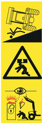
Existe grave riesgo de lesiones y peligro de muerte durante la carga y transporte de carga si está guiando el cargador frontal de un lado, se levanta la carga demasiado sobre el puesto de operador o bien se utiliza herramientas inapropiadas.
