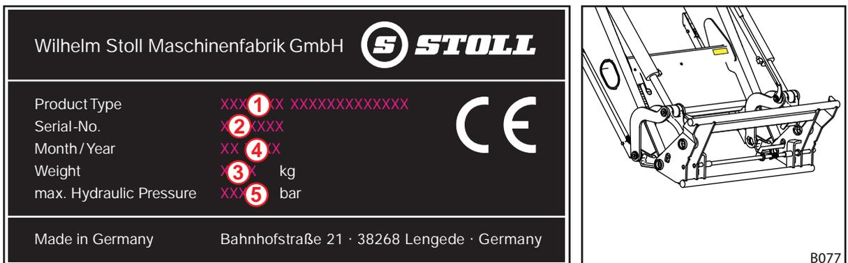
Fig. 1 Placa de características en el cargador frontal
