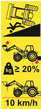
Existe riesgo de graves lesiones y peligro de muerte debido al vuelco del tractor al trabajar en pendientes, en desplazamientos con curvas, con insuficiente peso en el eje posterior y al coger carga diagonalmente.
