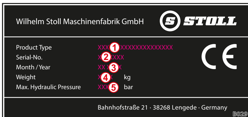
Fig. 1 Placa de características en el cargador frontal
