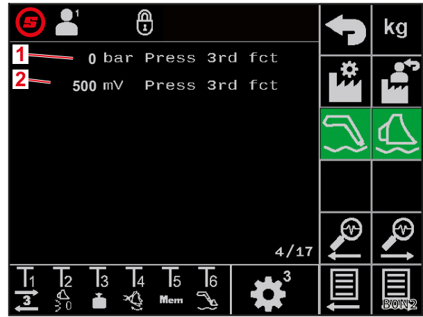
Şek. 40 3. kontrol devresindeki basınç sensörü
