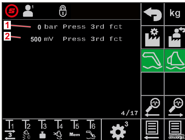
Ábr. 40 Nyomásérzékelő a 3. hidraulikakörben
