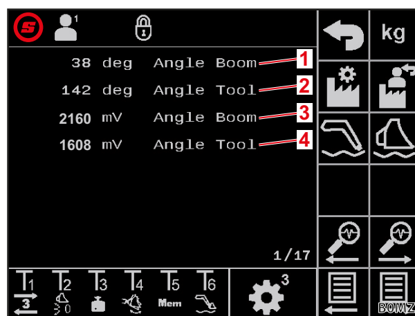
Ábr. 37 A gémszerkezet és a munkaeszköz szögérzékelői
